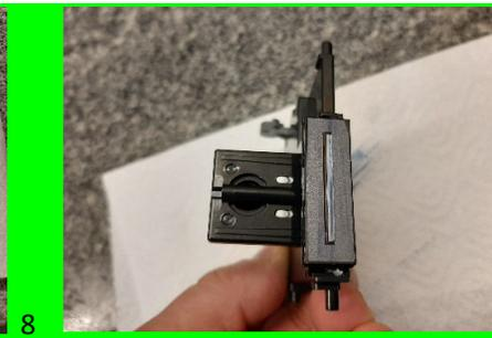
Setzen Sie die Düse und Tinte wieder ein vergewissern Sie sich, dass die Waage richtig auf dem Gerät sitzt, dann testen Sie den Ausdruck.
