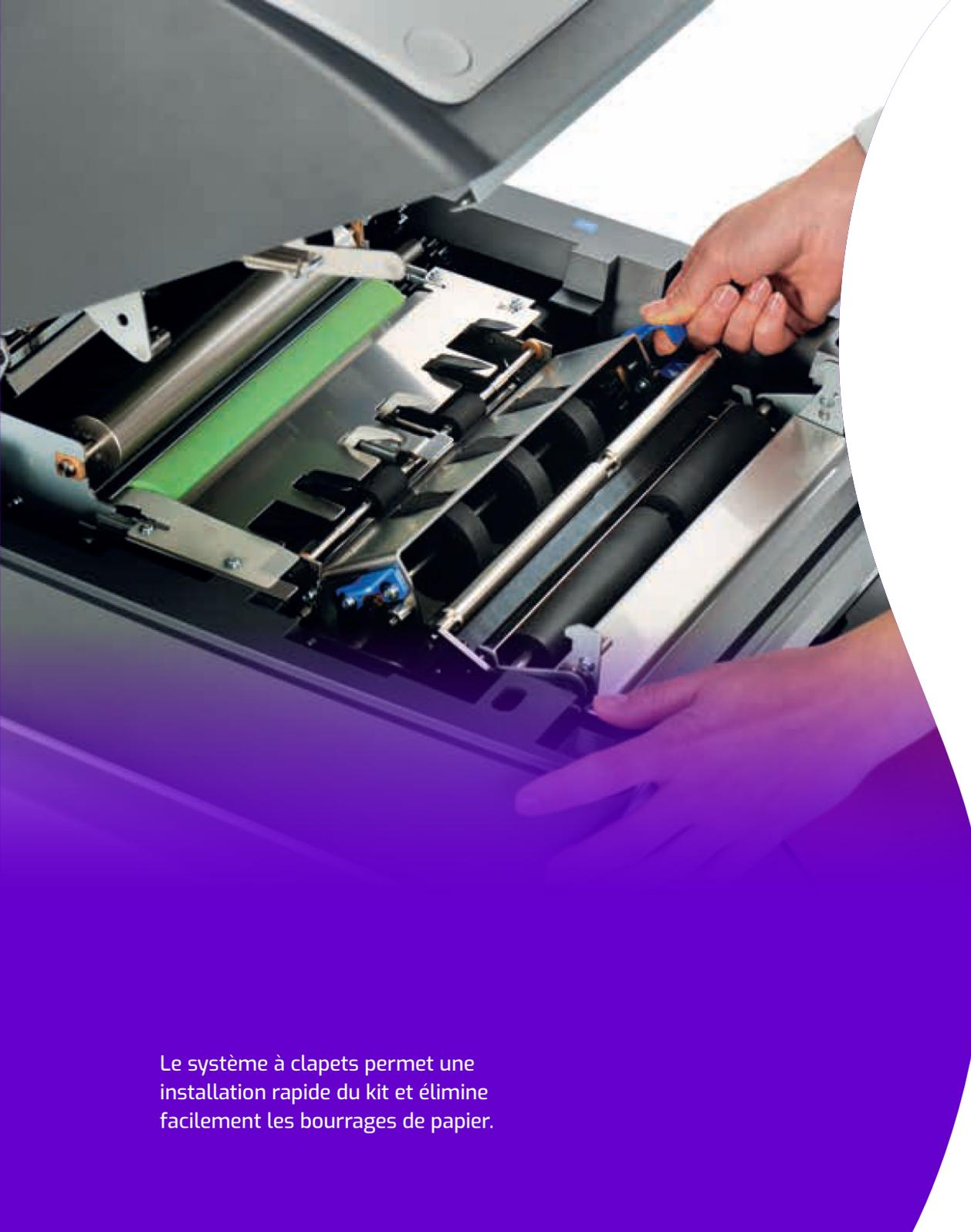
Le système à clapets permet une installation rapide du kit et élimine facilement les bourrages de papier.
