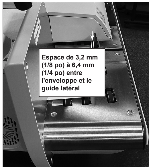
Figure 7.16 : Espace entre l'enveloppe et le guide latéral
